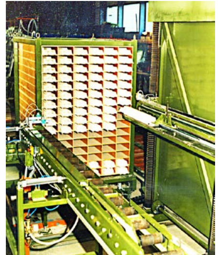
Sortierregal für 96 Profilpaare bei min. Verschnitt.
