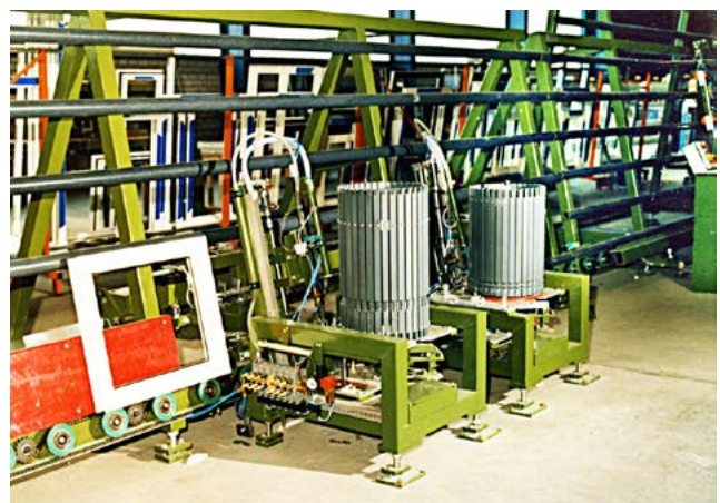
Schraubstation für 2 Sorten Schließbleche.
