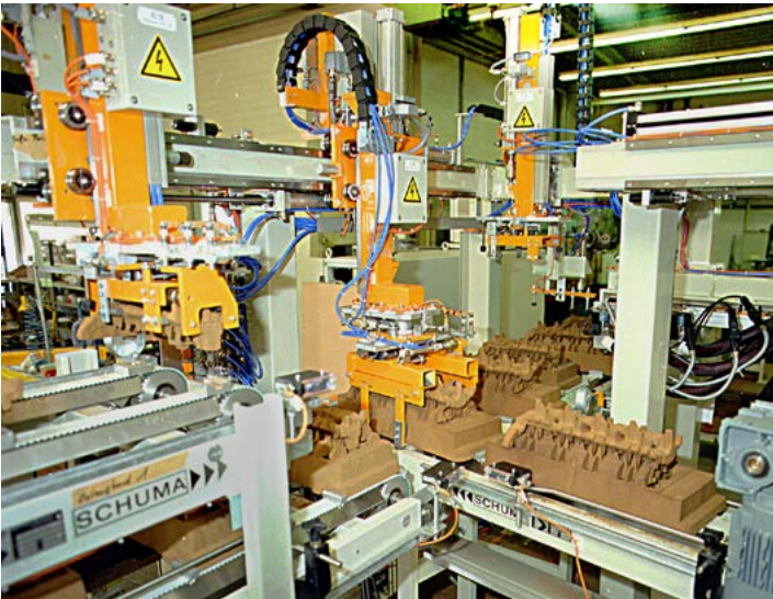
Gießkern für PKW Zylinderkopf aus Formsand.
