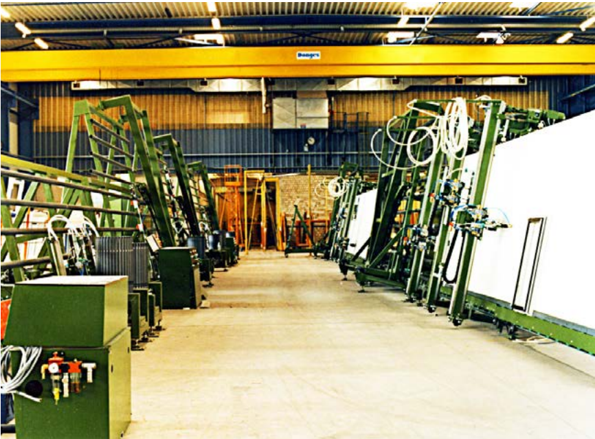
Die beiden Schraubstrassen für Blend- und Flügelrahmen.
